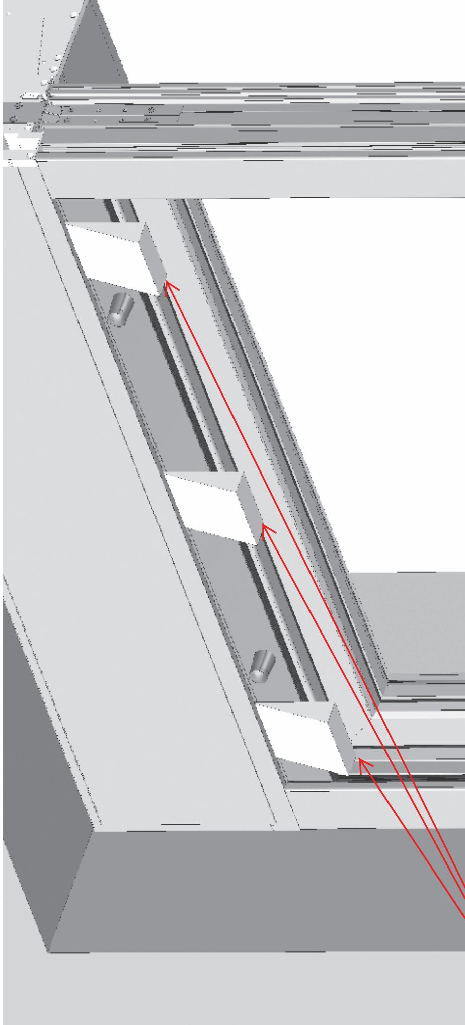
rys. kliny montażowe do obróbki zewnętrznej.
