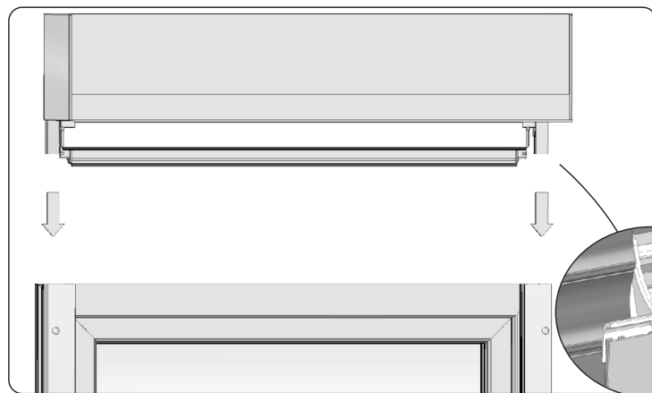
9. Dokładnie nasunąć skrzynkę na przewodnicę, ostrożnie wprowadzając trzpienie bocznych w górną część przewodnic. Wsunąć ostrożnie listwę dolną w taki sposób, aby nie uszkodzić siatki moskitiery.
